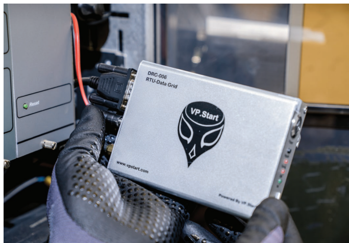
▲ គ្រាន់តែភ្ជាប់ DRC-006 ជាមួយ RTU T200i គឺអាចផ្លាស់ប្តូរទៅជាវីដ្យូតភ្លាមៗ
